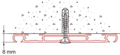
Montage au plafond du rail 2905 préperforé avec vis 2914-WD pourvue d'un cache blanc.
