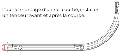
Pour le montage d'un rail courbé, installer un tendeur avant et après la courbe.
