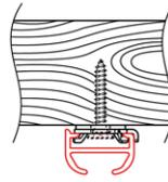
montage au plafond avec support 2650 (avec rondelle), avec vis à bois 2614
