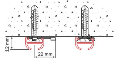
montage au plafond avec support 2650 (avec rondelle), avant (a) et après (b) le serrage du tendeur.
