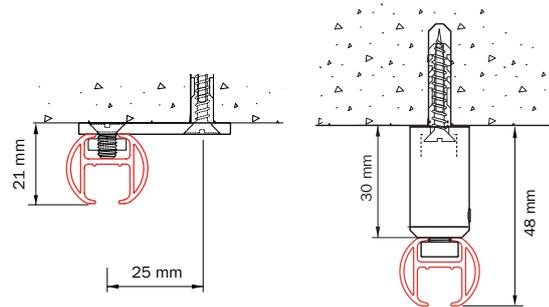
Montage au mur 4200 avec support 4249
