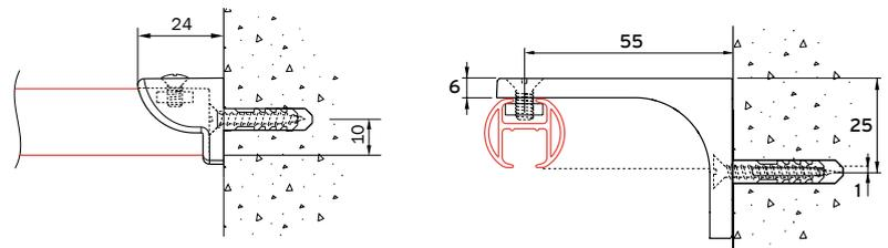
Montage au plafond 4200 sur un pied 4055-40 avec kit de montage 4055-30, pied avec extrémité fileté 4055-10.
